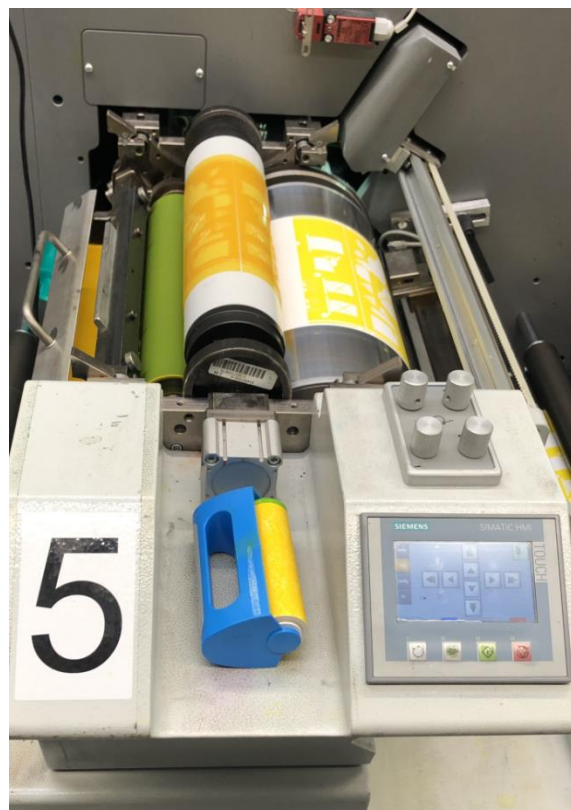
Rysunek 31. Jedna sekcja w maszynie fleksograficznej
